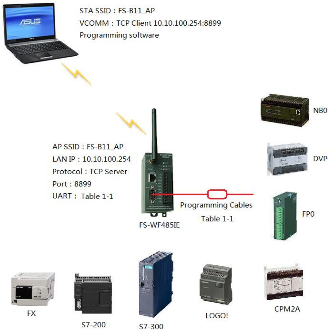
图 1-1 带有 RS232/RS485/RS422 串口的 PLC 无线编程监控
