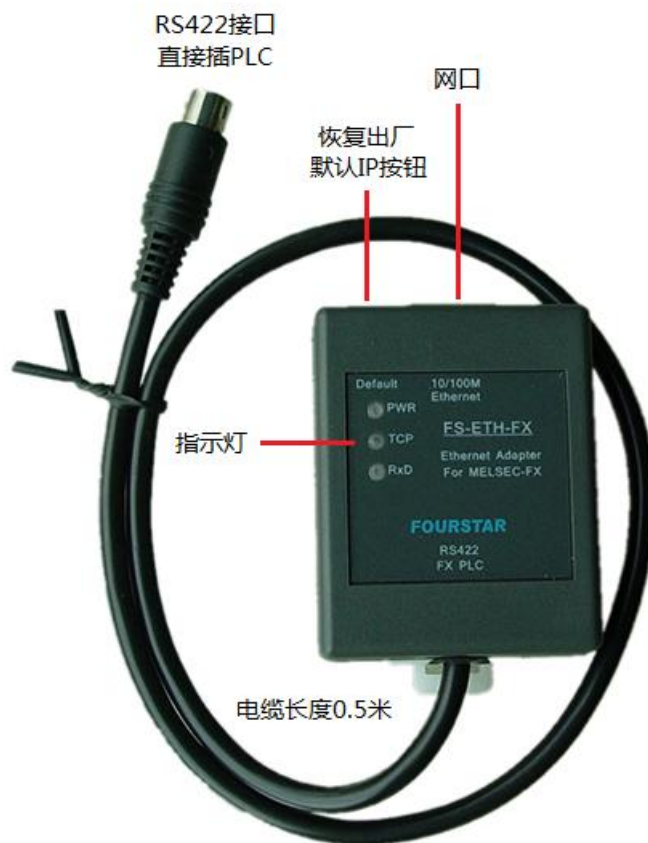
图3-1 FS-ETH-FX的外部结构及各部件说明
